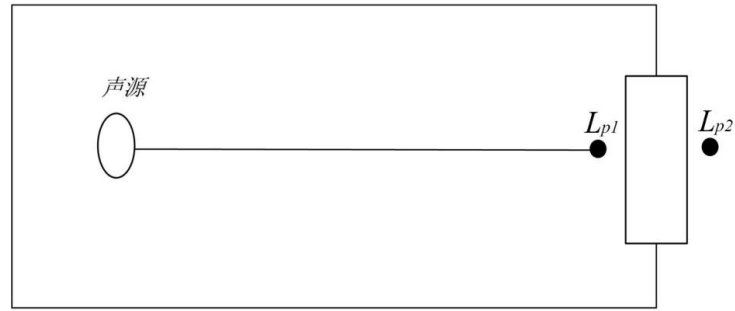
图 4-1 室内声源等效为室外声源图例
