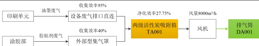
图 4-1 本项目非甲烷总烃治理流程图
