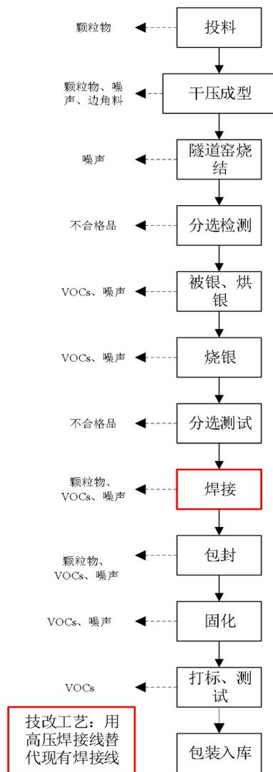
图 2-6 电容器件工艺流程及产污环节图
