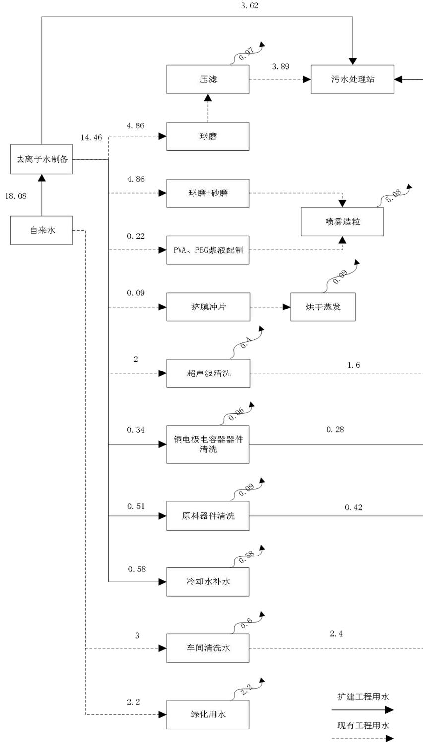
图 2-1 水平衡图 (单位: m³/d)
