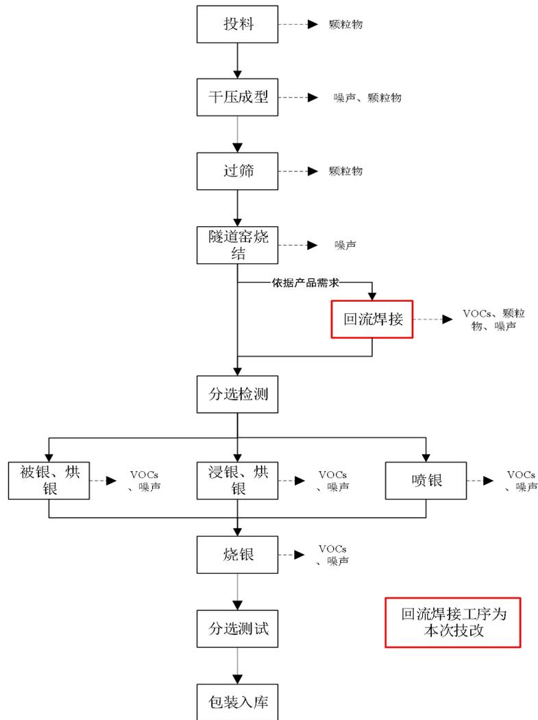
图 2-6 微波介质器件工艺流程及产污环节图
