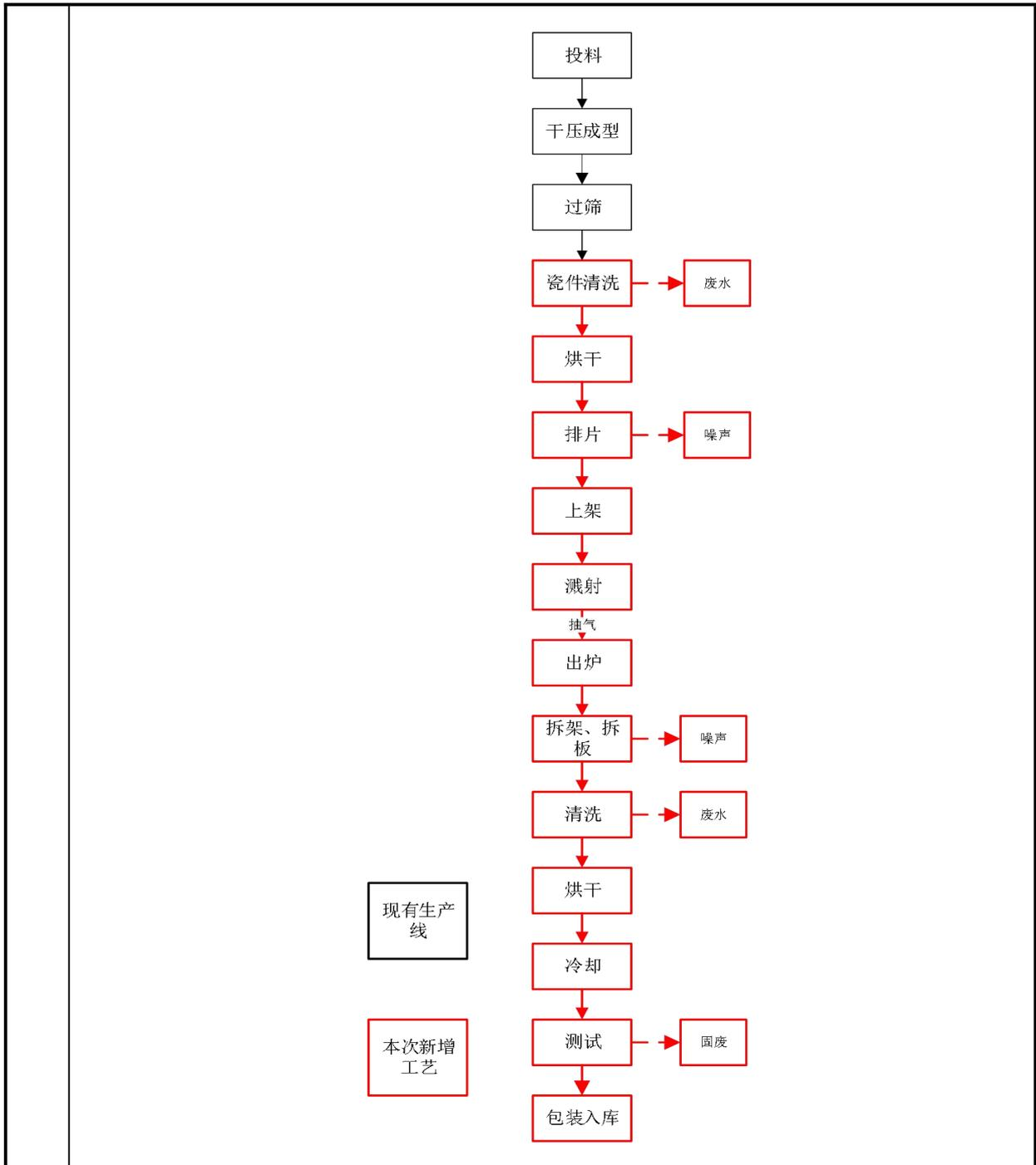
图 2-5 铜电极电容器件工艺流程及产污环节图
