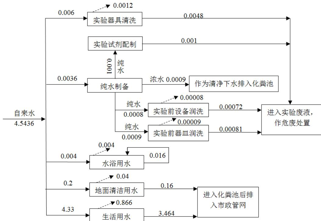
图 2-1 项目水平衡图 (单位: m<sup>3</sup>/d)
