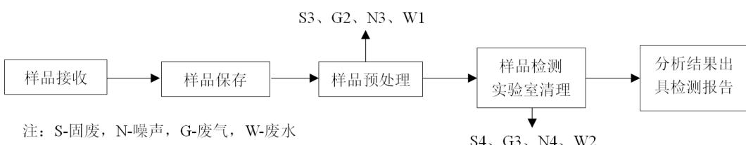
图 2-4 化学性检测流程及产污环节图
