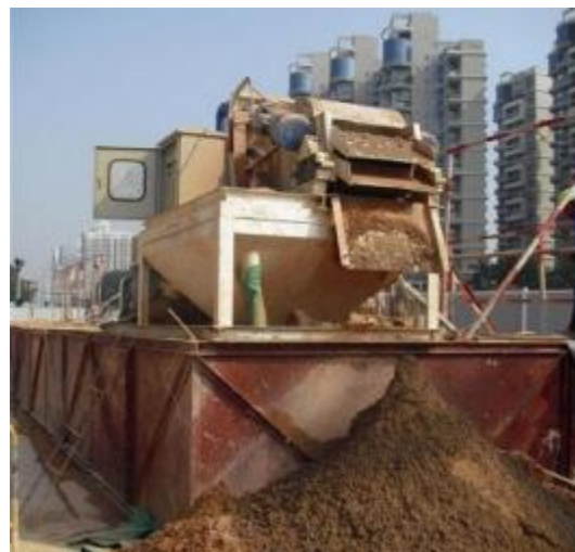
1—振动筛细筛层；2—振动筛粗筛层；3—循环过滤槽；4—液下螺杆泵；5—渣浆泵；6—电机；7—粗浆池；8—静浆池；9—溢流补水箱；10—旋流分离器
