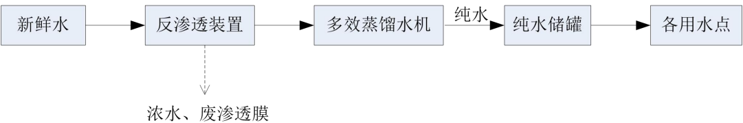
图 2.2 纯水制备工艺流程
