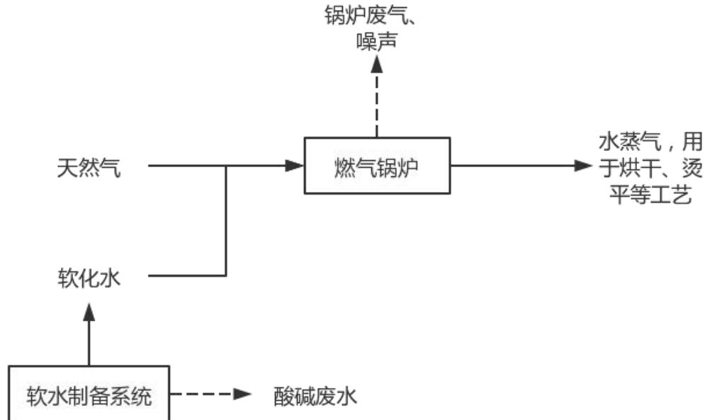
图 1 燃气锅炉工艺流程和产污环节图
